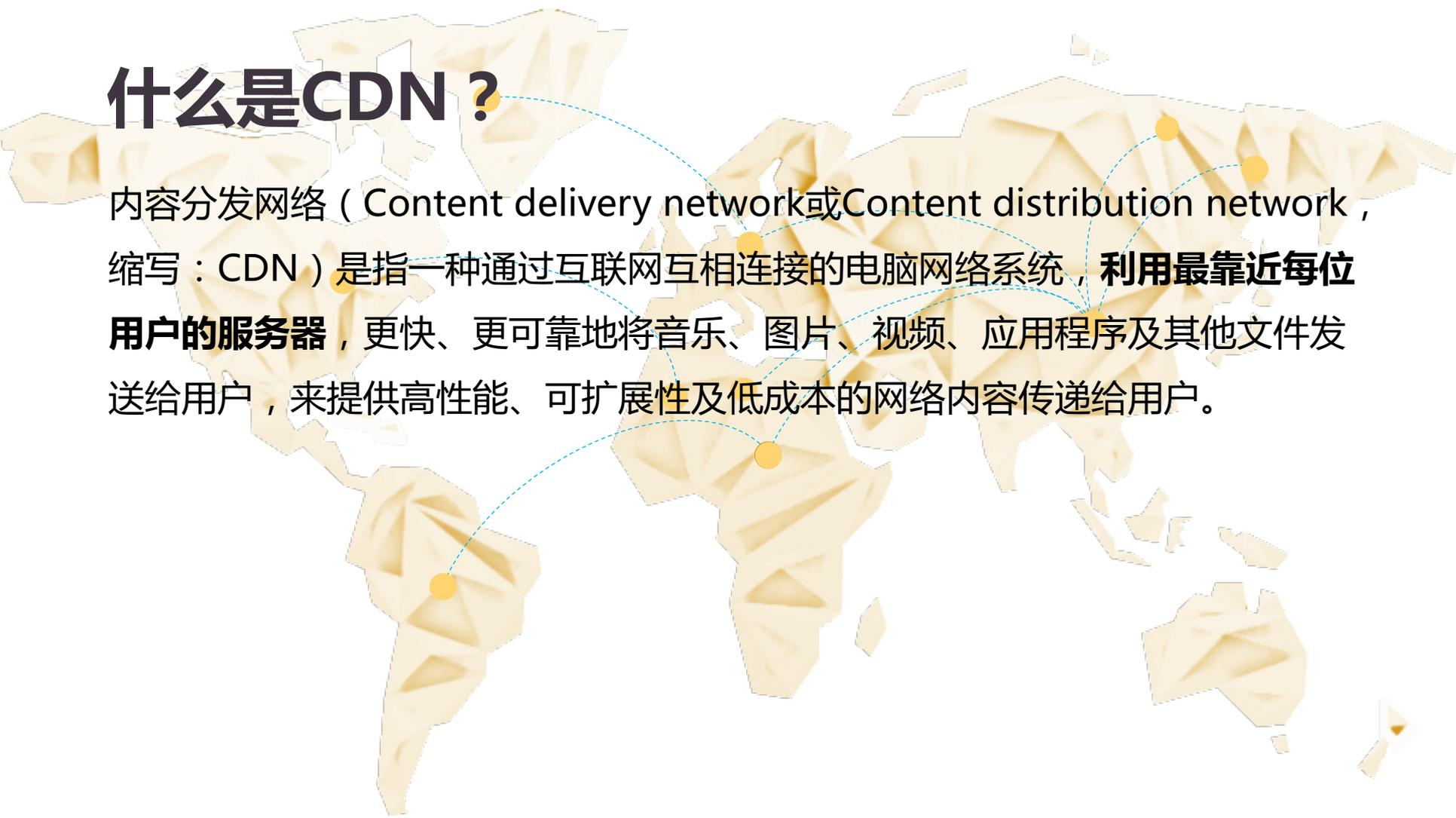
内容分发网络 ( Content delivery network或Content distribution network , 缩写 : CDN ) 是指一种通过互联网互相连接的电脑网络系统 , **利用最靠近每位用户的服务器** , 更快、更可靠地将音乐、图片、视频、应用程序及其他文件发送给用户 , 来提供高性能、可扩展性及低成本的网络内容传递给用户。
