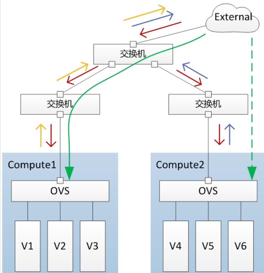
因为路由器的外部接口ARP响应流表是通过全量下发的方式下发到区域内所有的OVS中，所以所有的OVS都会对外部数据的ARP请求进行响应。
