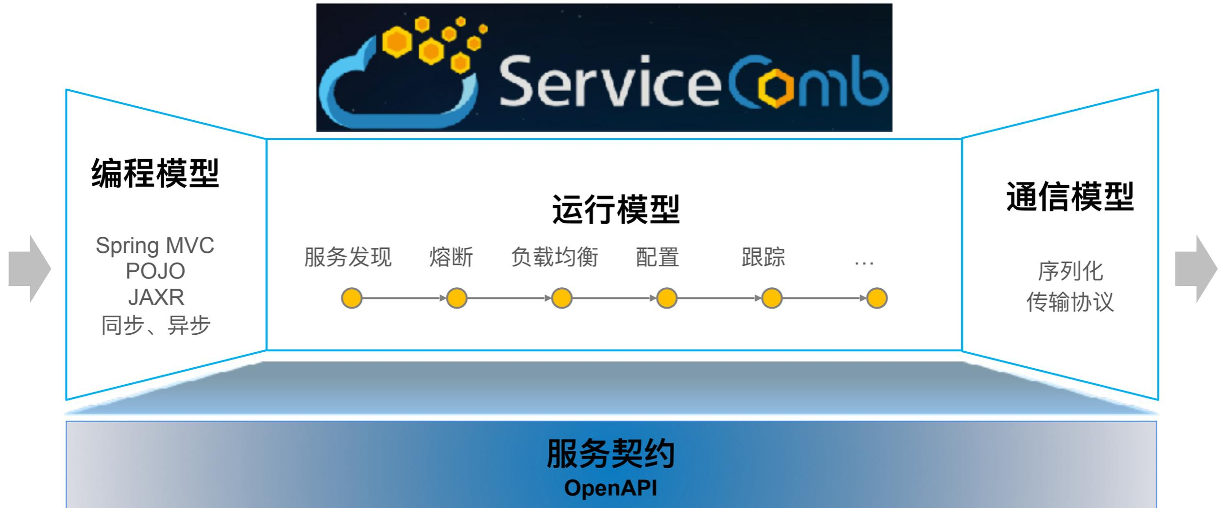
**编程模型：**支持Spring MVC、POJO、JAXR以及异步的方式
