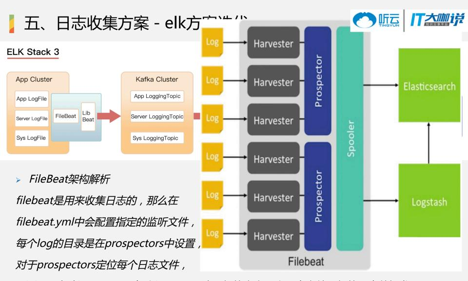
Filebeat启动harvester。每个harvester读取新的内容一个日志文件,新的日志数据发 送到spooler(后台处理程序),它汇集的事件和聚合数据发送到你已经配置了Filebeat输出。
