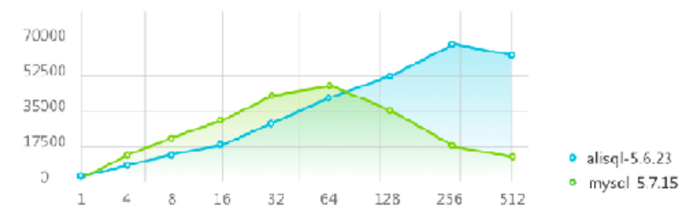
精心打磨InnoDB，挑战性能极限 在cysbench的update_non_index方案下，并发超过64线程后开始优势明显
