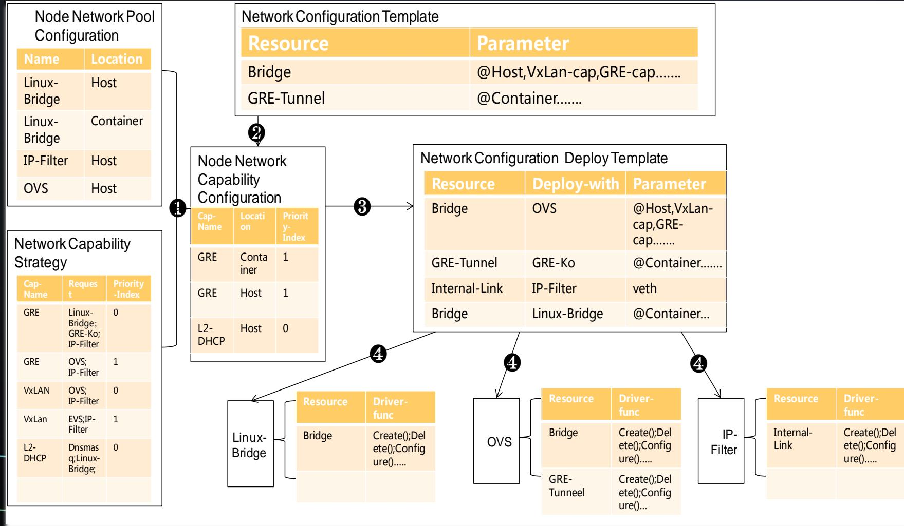
**①** Network-Agent Local 初始化，根据本地资源池（Node Network Pool Configuration）及网络能力策略库（Network Capability Strategy），综合得出节点网络能力配置部署能力表（Node Network Capability Configuration 维护）；
