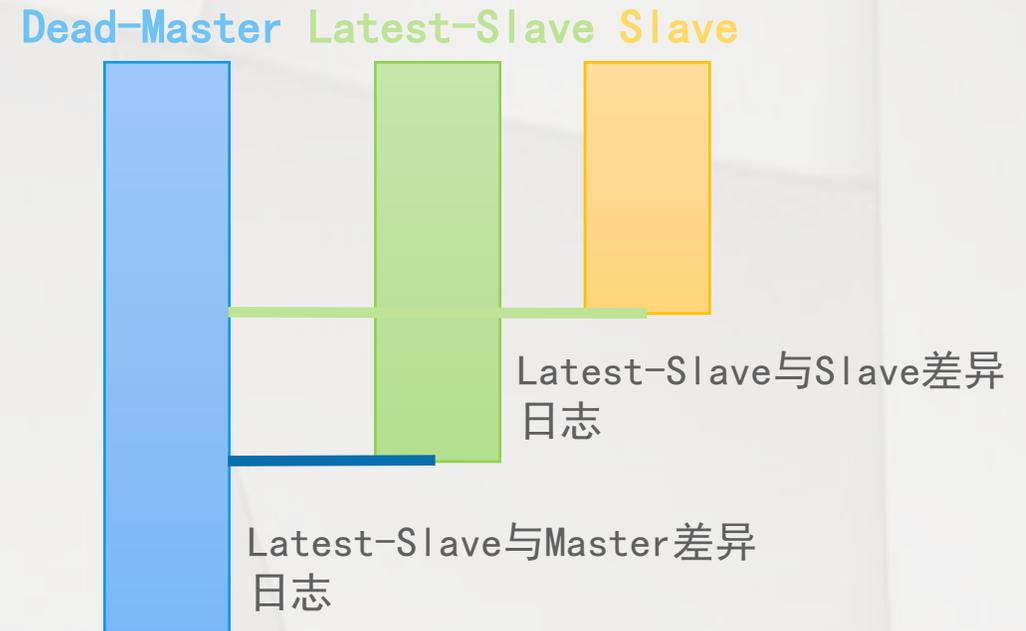
Master故障时试图通过Rsync拉取Binlog，最大程度保证数据不丢失；
